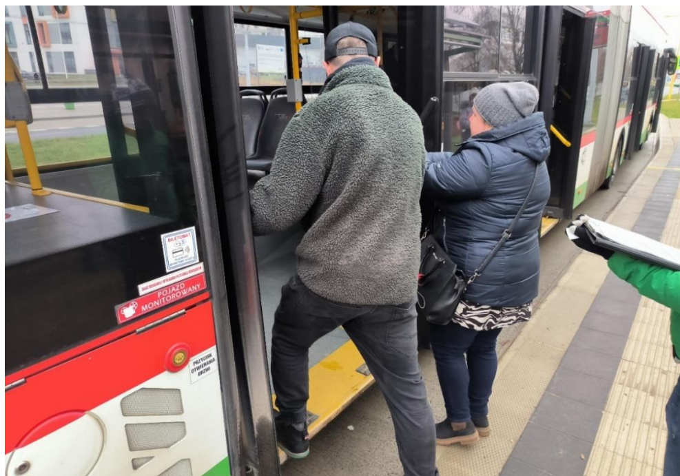
Rysunek 19. Podczas wsiadania do pojazdu konieczna była pomoc asystenta. Widać również oznaczenie pola uwagi na przystanku zbyt blisko krawędzi – Lublin
